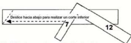
Para 60°, realice un cuadrado con 7 en Gancho y 12 en Cuerpo en el borde del Panel Inclinado para trazar líneas para cortes. Luego realice cortes de 1 1/2" a 90° para que descienda el corte.
